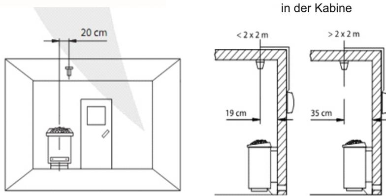
Diagramm für die Lichteinheit der Sauna
