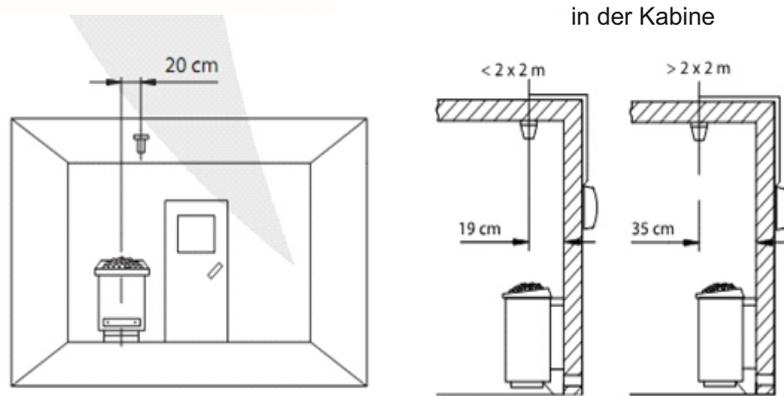
Diagramm für die Lichteinheit der Sauna
